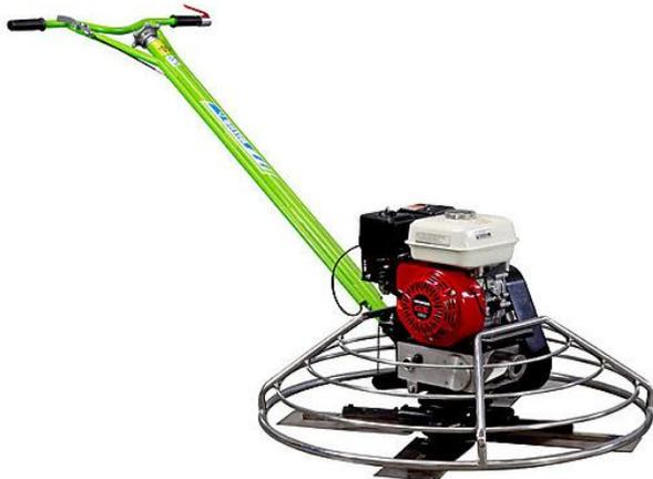
Бензиновая затирочная машина SIMA HALCON 95 с бензиновым двигателем Honda GX160 и лезвиями длиной 900 мм для выравнивания поверхности бетона, придания необходимой шероховатости спустя 5-10 часов после его заливки и уплотнения при помощи затирочного диска и лопастей. Машина справляется с большими площадями и способна работать длительное время без обслуживания.
