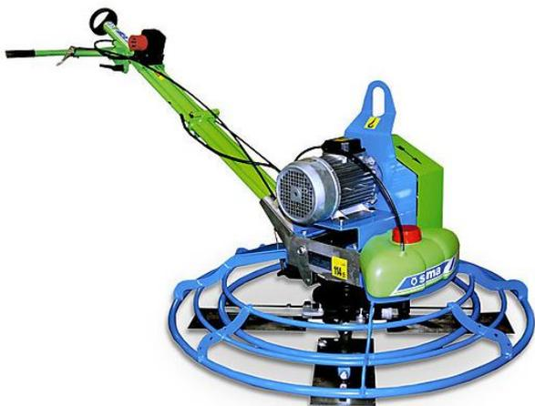
Затирочная машина SIMA HALCON 90 типа "вертолет" с электрическим трехфазным приводом мощностью 2,2 кВт и лезвиями длиной 950 мм для чистовой отделки поверхности бетона, спустя 5-10 часов после его заливки и уплотнения, при помощи затирочного диска и лопастей.
