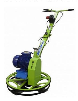
Затирочная машина SIMA HALCON 65 380E применяется для работы на небольших площадях, при обработке стыков, краев, стен. Машина оснащена электрическим двигателем мощностью 2,2 кВт, работает от сети 380В. Машина может работать как лопастями, так и затирочным диском, диаметром 600 мм. Машина покрытым эпоксидным полиэстром для защиты от коррозии. Кнопка аварийной остановки на рукоятке позволит избежать экстренных ситуаций. Вес оборудования 53 кг.
