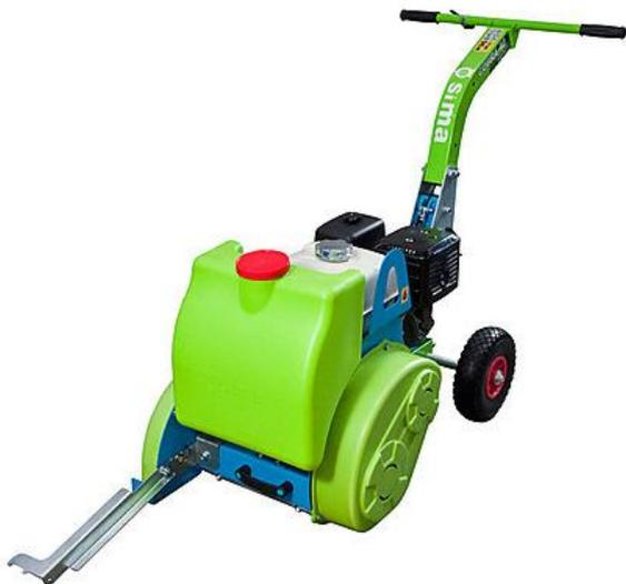
Легкий и компактный швонарезчик с бензиновым двигателем Honda GX-270 мощностью 13 л.с. или Kohler SN390 мощностью 14 л.с. для нарезания швов в асфальте, бетоне, плитке или мозаике (террасцо) глубиной до 132 мм. Простая и в то же время, надежная конструкция резчика, тонкая настройка и регулировка почти всех узлов. Движение резчика осуществляется толканием. Емкость с водой смонтирована на рукоятке управления, вода самотеком поступает в зону реза без насоса.
