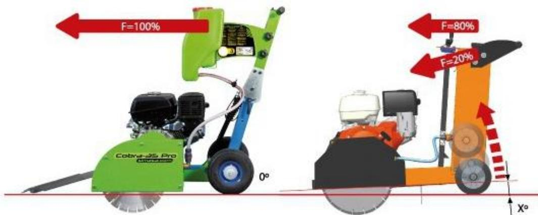
Точно так же, как и модели серии Cobra Pro, эта серия обладает наличием параллельного направления угла реза к обрабатываемой поверхности. Это существенно увеличивает эффективность работы резчика, а так же облегчает работу оператора, так как вся сила направлена в одном направлении (только вперед), а не в двух (вперед и вниз).
