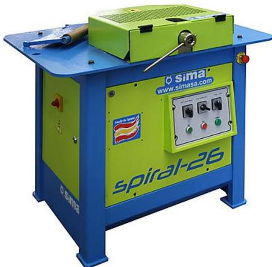
SIMA сконструировала станок, который предназначен для выполнения операций по производству спиралей из арматуры как гладкой, так и с ребрами жесткости. Так же, его используют при выпрямлении изогнутой арматуры. Три регулируемых по осям ролика создают необходимый угол сгиба, а два свободно вращающихся валика помогают удерживать арматуру в ровном положении. Корпус станка выполнен из прочного металла, и окрашен эпоксидным полиэфиром для стойкости коррозии.
