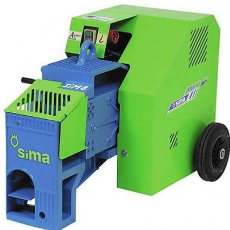
Машина Sima CEL 52 P для резки гладкой арматуры или арматуры с поперечными ребрами жесткости (гофрированной) диаметром до 36 мм при помощи двух стальных сменных ножей. Мощность привода станка позволяет резать до трех прутков одновременно, что значительно сокращает время работы. Подача арматуры в зону реза производится вручную, а резка производится путем нажатия рычага или педали.
