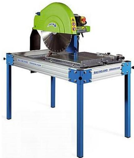
Станок камнерезный BALI 500 Мекано с электрическим однофазным или трехфазным приводом мощностью 2,2/3,0 кВт, длиной стола 750 мм и возможностью работы с дисками диаметром 500 мм для прямой или косой резки различных материалов на строительной площадке. Диаметр диска позволяет обрабатывать различные материалы высотой до 200 мм.
