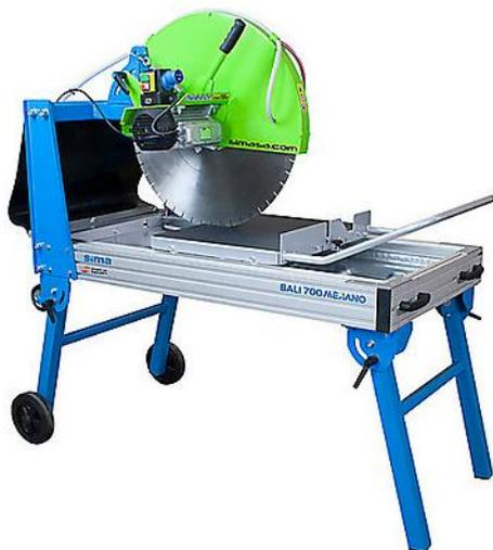
Станок камнерезный BALI 700 Мекано с электрическим однофазным или трехфазным приводом мощностью 3,0 кВт, длиной стола 540 мм и возможностью работы с дисками диаметром 700 мм для прямой резки различных материалов на строительной площадке. Диаметр диска позволяет обрабатывать различные материалы высотой до 355 мм за два прохода.
