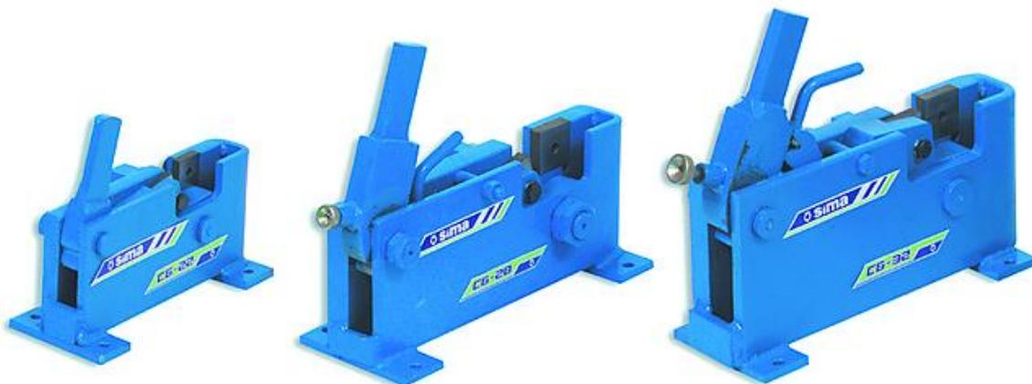
Ручной инструмент для резки арматурных прутков диаметром 22, 28 и 32 мм при помощи высокопрочного инструмента с лезвиями приводимыми в движение при помощи длинного рычага. Уникальная система сближения режущих лезвий требует меньших усилий от оператора. Данные ножницы решают задачу по резке арматуры высокого сопротивления.
