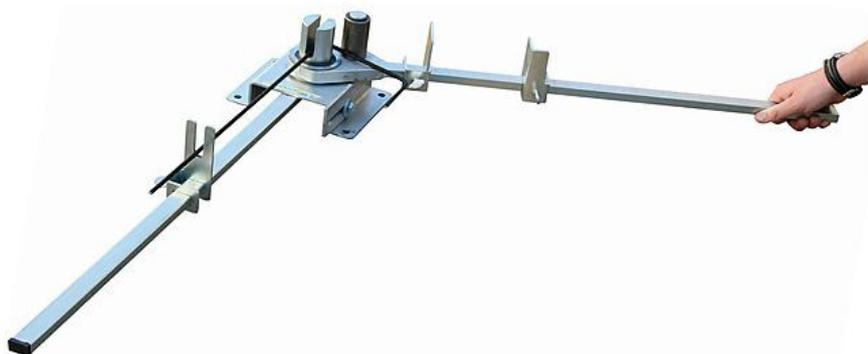
Простой по конструкции инструмент для ручной гибки арматуры, позволяет сгибать несколько прутьев диаметром до 12 мм за один проход одновременно. Для удобства использования, инструмент оборудован градуировочной шкалой. Он прекрасно подойдет на небольших и частных строительных объектах в гражданском строительстве. Либо пригодится в качестве вспомогательного средства на площадках с частыми отключениями электричества.
