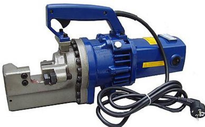
Ручные электрогидравлические ножницы с однофазным электроприводом мощностью до 1440 Вт для резки арматурных прутков как гладких так и усиленных ребрами жесткости, диаметром от 4 до 25 мм, непосредственно, на строительной площадке. Быстрый и простой в обращении инструмент, который не требует от оператора специфических знаний или определенной квалификации.
