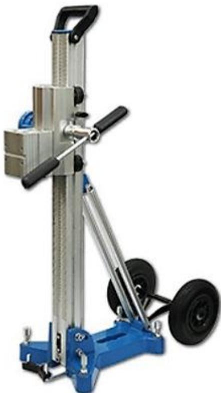
Опорная стойка для двигателя алмазного бурения, высотой 950 мм рассчитанная на бурение бетона, кирпича, природного камня алмазными коронками диаметром до 162 мм. Крепкая конструкция из нержавеющей стали, основание рассчитанное для использования с вакуумным насосом. Лазерный указатель существенно упрощает "прицеливание" к центру отверстия. Транспортировочные колеса помогают передвигать установку алмазного бурения по строительному объекту.
