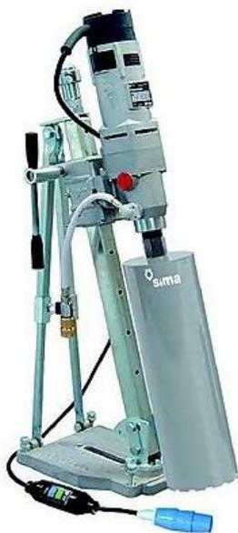
Установка алмазного бурения SIMA Торо 2 с однофазным электродвигателем мощностью 2.5 кВт, трехскоростным редуктором и коронками алмазного бурения от 25 до 220 мм для бурения отверстий в бетоне, камне, железобетонных конструкциях в гражданском и промышленном строительстве при бурении отверстий под различные коммуникации, при установке кондиционера, отопления, вытяжки и в других случаях.
