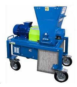
Измельчитель мусора Sima Triton 220V оборудован электрическим двигателем мощностью 4 кВт, работает от сети 220В. Установка используется для измельчения строительного мусора на мелкие песчинки. Загрузочное отверстие 40х40 см. Производительность 1/1,5/2,5 м³/ч. При отсутствии в мусоре гипса, металла или дерева, измельчитель преобразует его в песок для производства строительного раствора. В комплектацию входят три вида сита для получения фракций песка (1,5 / 10 / 40 мм). Вес оборудования 180 кг.
