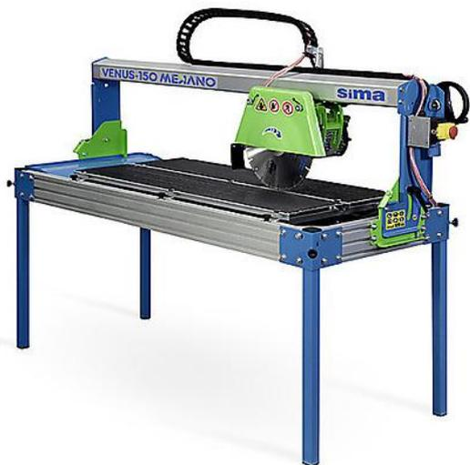
Станок камнерезный SIMA Venus 150 Мекано с электрическим однофазным или трехфазным приводом мощностью 2,2/3,0 кВт, длиной стола 1550 мм и возможностью работы с дисками диаметром 300/350 мм для прямой или косой резки различных материалов на строительной площадке.
